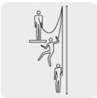
Distancia mínima al suelo desde el punto de anclaje 6 m
